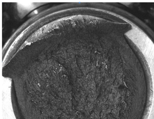
Рисунок 7 - Вид излома со стороны подшипника
