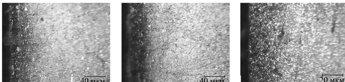
Рисунок 3 - Микроструктура быстрорежущих сталей после электролитно-плазменного азотирования при T = 550\text{ }^{\circ}\text{C} : а) P9; б) P6M5; в) P18
