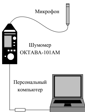
Рис. 13. Структурная схема измерительной системы с частотным анализом шума
