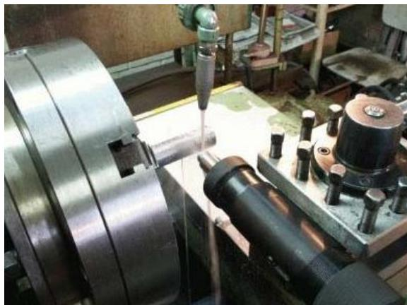
Рис. 1.4. Ультразвуковая импульсная упрочняюще-чистовая обработка деталей
