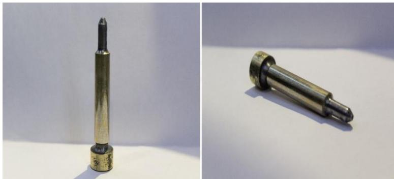
Рис. 6.3. Внешний вид иглы распылителя форсунки дизеля с покрытием нитрида титана
