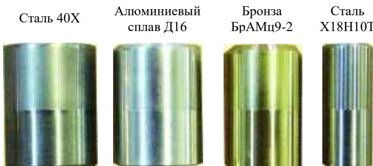
Рис. 1.6. Образцы деталей из различных материалов, обработанные УЗО
