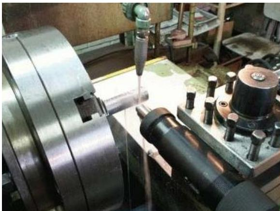
Рис. 1.4. Ультразвуковая импульсная упрочняюще-чистовая обработка деталей
