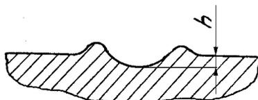
Рис. 2.2. Форма пластических деформаций отпечатков, оставляемых роликом на поверхности детали
