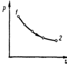
Рисунок 4.1- Изображение термического процесса на p - v диаграмме
