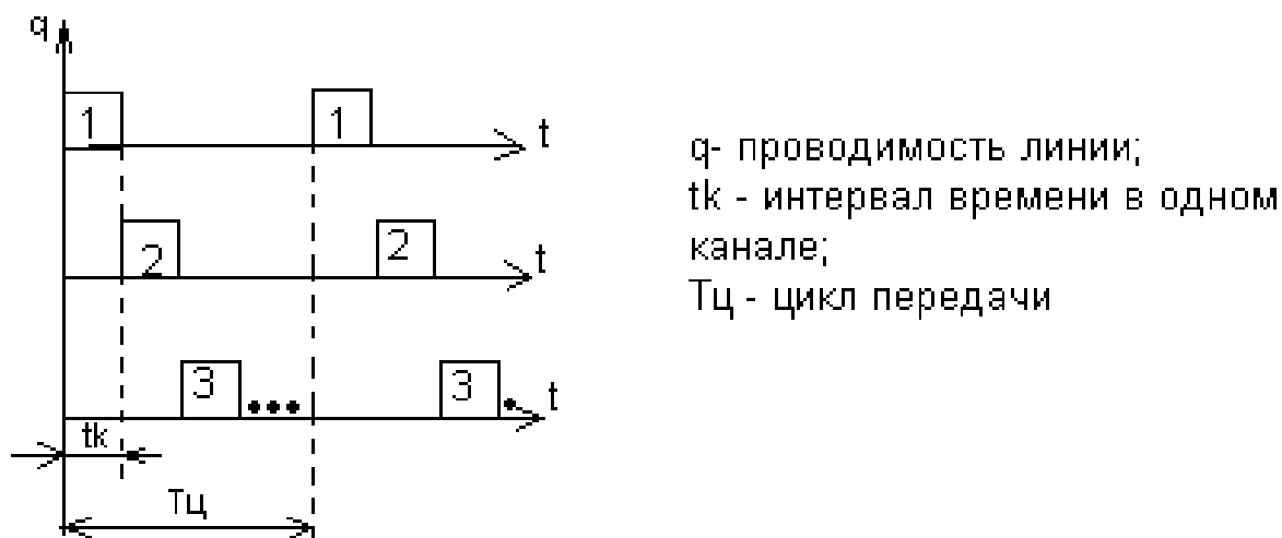
Рисунок 3.2 – Схема цикла передачи
