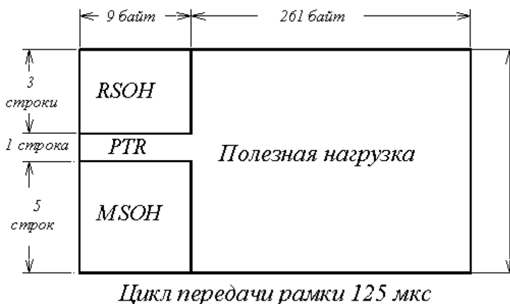
Рисунок 4.1 – Структура синхронного транспортного модуля STM-1
