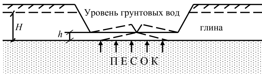
Рис. 5.31. Поднятие дна котлована при гидростатическом действии воды
