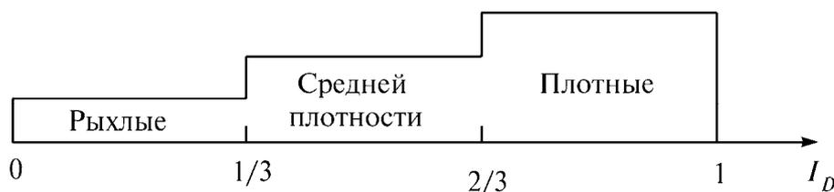
Рис. М.3.16. Классификация сыпучих грунтов по плотности
