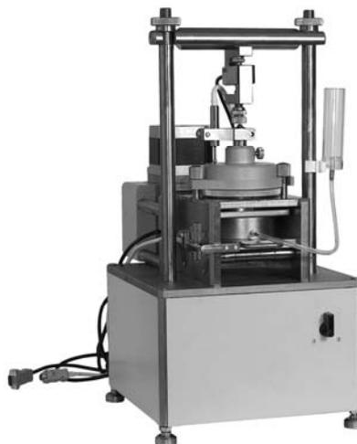
Рис. М.11.4 (окончание). Общий вид приборов прямого среза ([www.geotek.ru](http://www.geotek.ru)):
