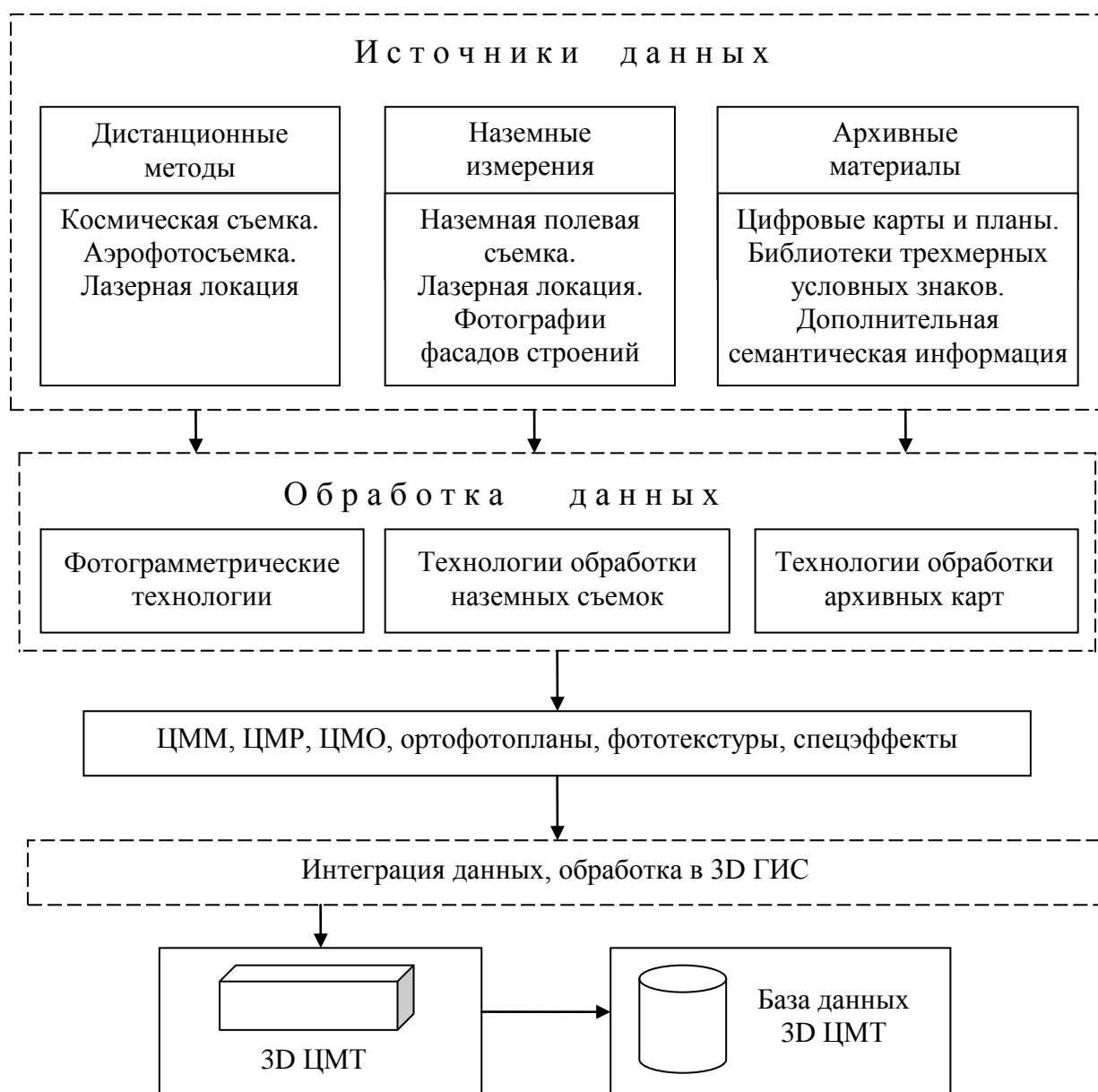
Рис. 1.3. Обобщенная схема построения измерительных трехмерных видеосцен по различным данным
