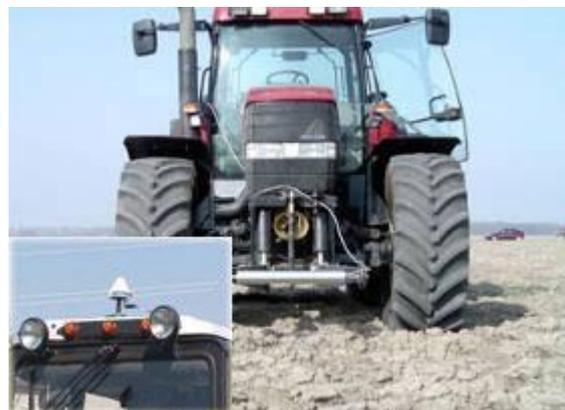
С помощью систем спутниковой навигации можно ездить и прямолинейно и криволинейно, главная идея состоит в том, чтобы свести к минимуму перекрытия и пропуски между соседними загонками и при этом произвести расходы только на оборудование и быстрое обучение, а не, к примеру, на работы по расстановке вешек или частой замене пены маркера. При этом параллельные линии могут быть как прямыми, так и кривыми.
