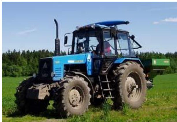
Рисунок 1 - МТЗ-1221 с установленным Hydro-N-Sensor и Amazone ZA-M 1500
