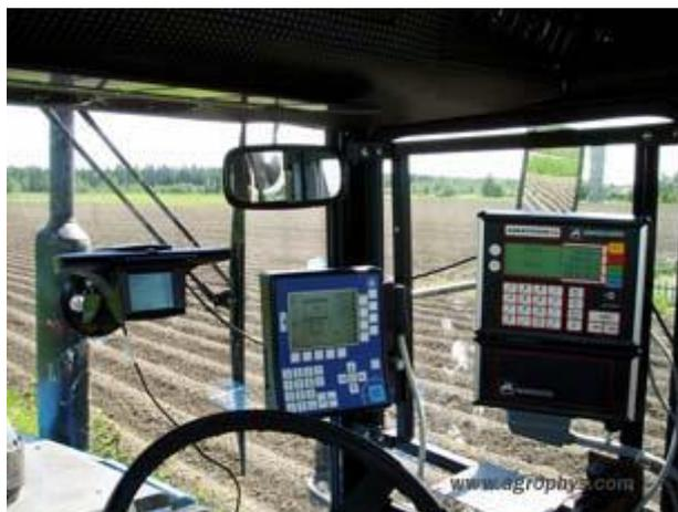
Рисунок 2 - Кабина МТЗ 1221 с установленными бортовыми системами для точного земледелия
