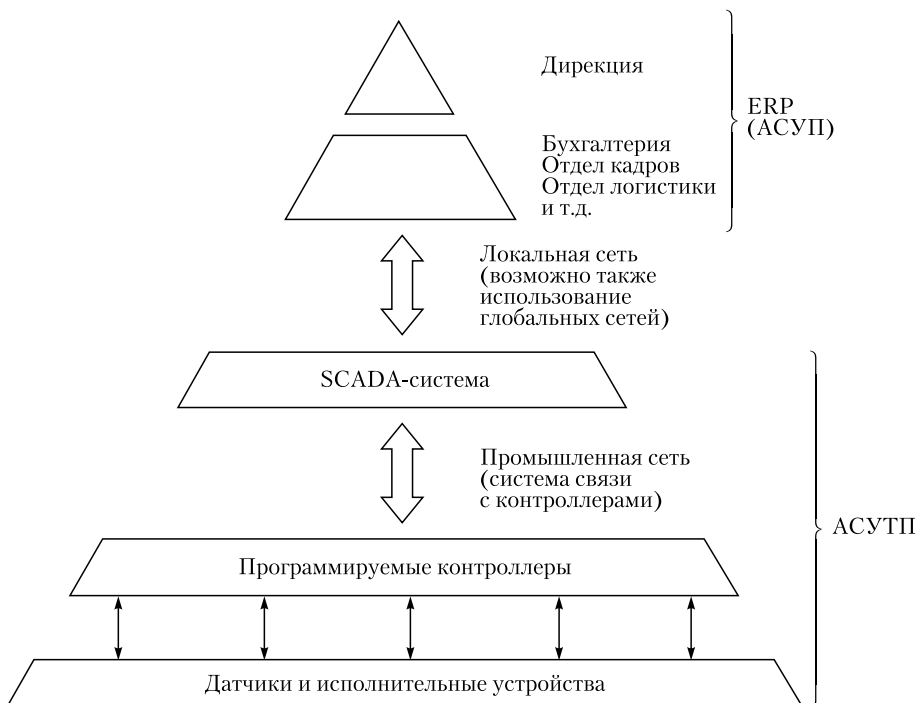
Рис. 1.3. Функциональная схема АСУ сложным техническим объектом на базе ПЛК
