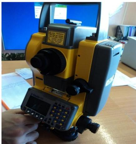
Рисунок 2.3 – Электронный тахеометр
