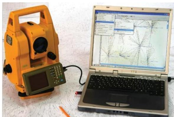
Рисунок 2.7 – Ввод геодезической информации в программу IndorCAD
