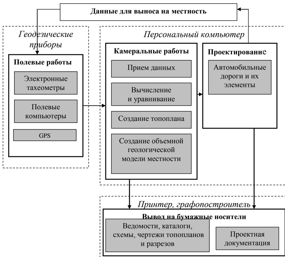
Рисунок 2.2 – Замкнутая технология проектно-изыскательских работ
