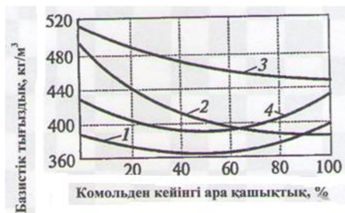
5.2-сурет. Сүрек тығыздығының дің ұзындығы бойынша өзгеруі [16]: а – шырша; б – қарағай; в – қайың; г – көктерек
