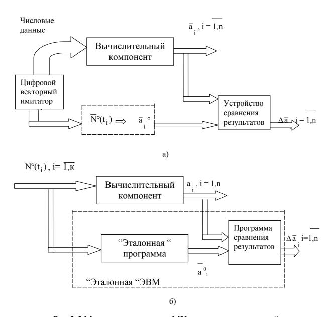
Рис. 3.5 Методы определения МХ программ вычислений
