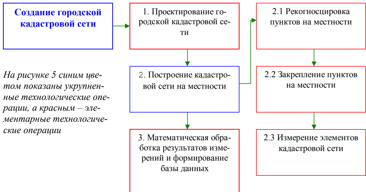
Рис. 5 Структурная схема разложения укрупненной операции на элементарные технологические операции (декомпозиция)
