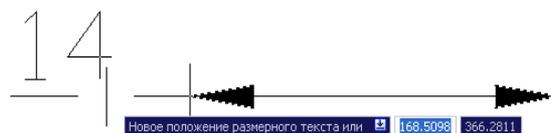
Рисунок 72- Изменение местоположения размерного текста
