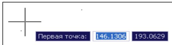
Рисунок 21 Динамическое отслеживание координат курсора
