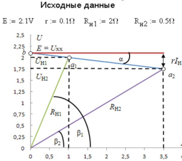
Рис. 2.16. Определение внутреннего сопротивления ИН графоаналитическим способом
