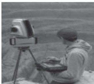
12.9-сурет. Тұрақты пунктке орнатылған лазерлі сканер, сканирлеу және планшеттегі скандарды тексеру.
