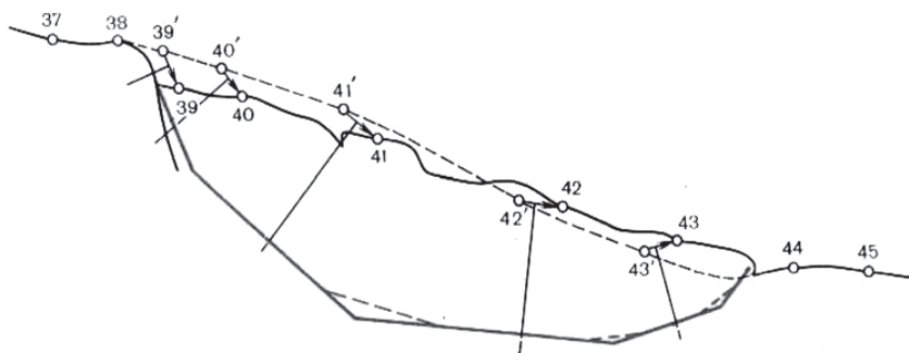
12.6-сурет. Маркшейдерлік аспаптық бақылаулар нәтижесінде сырғу сызығының орнын анықтау схемасы
