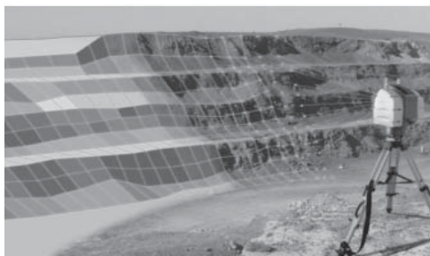
12.9-сурет. Тұрақты пунктке орнатылған лазерлі сканер, сканирлеу және планшеттегі скандарды тексеру.
