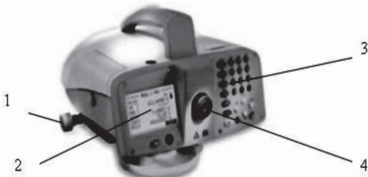
6.6-сурет. Жоғары дәлдікті DNA 03 – нивелирі: 1 – горизонталь жазықтықтағы жетекші винті; 2 – дисплей; 3 – жұмыс істеу функцияларын реттейтін пернелер; 4 – көру дүрбісі.
