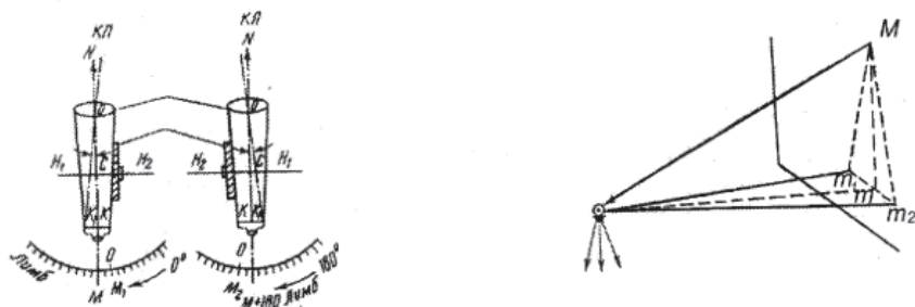
5.14-сурет. Теодолиттің тексерілуі
