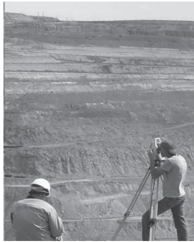
12.7-сурет. Leica TCR 1201 тахеометрімен бақылау жүргізу: а – репер үстіне орнатылған шағылдырғыш; ә – тірек пунктіндегі тахеометр
