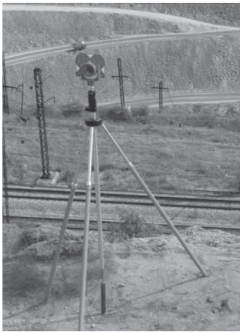
12.7-сурет. Leica TCR 1201 тахеометрімен бақылау жүргізу: а – репер үстіне орнатылған шағылдырғыш; ә – тірек пунктіндегі тахеометр
