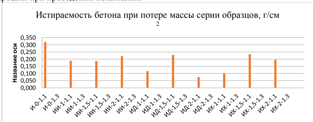
Рисунок 4 – Истираемость бетона с учетом потери массы серии образцов.
