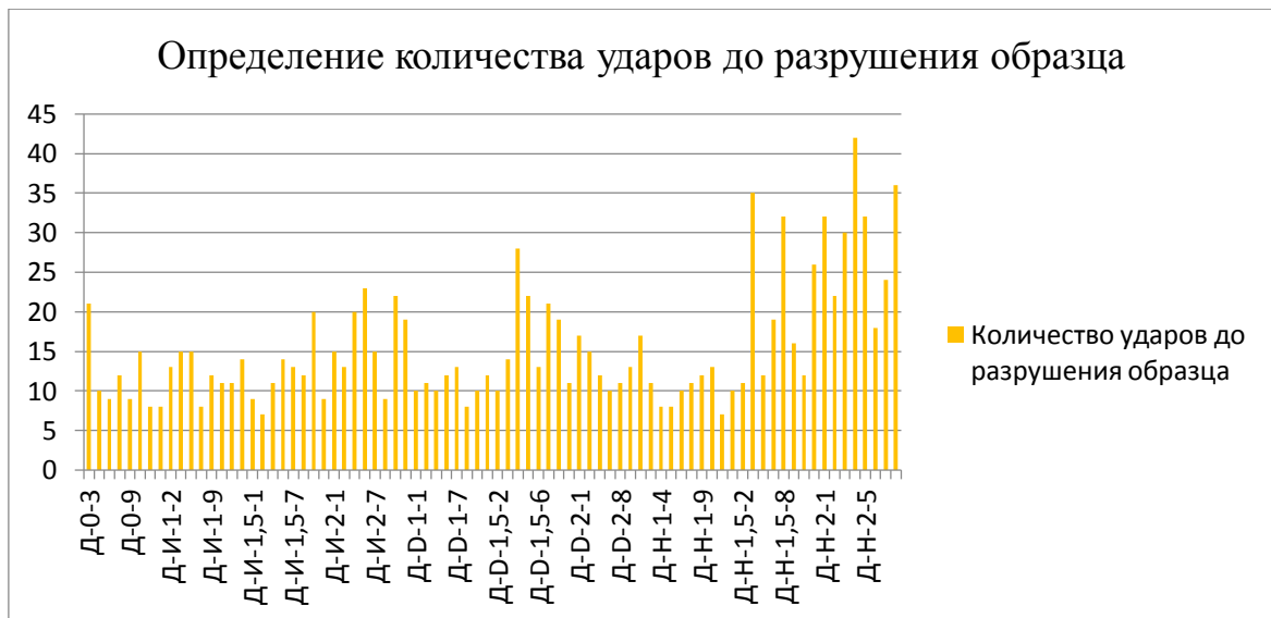
Рисунок 2 – Гистограмма распределения количества ударов до разрушения образца.
