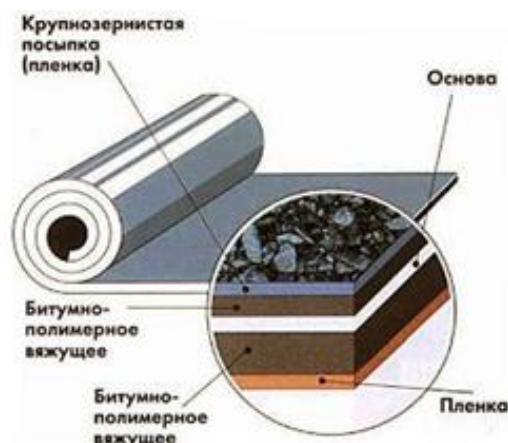
Рисунок 1 - Устройство кровельного материала.
