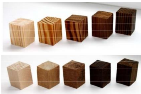
Рисунок 1 – Фотографии образцов древесины сосны (верхний ряд) и березы (нижний ряд) после термической обработки: а – необработанные образцы; б, в, г и д – образцы, обработанные по 1, 2, 3 и 4-му режимам соответственно
