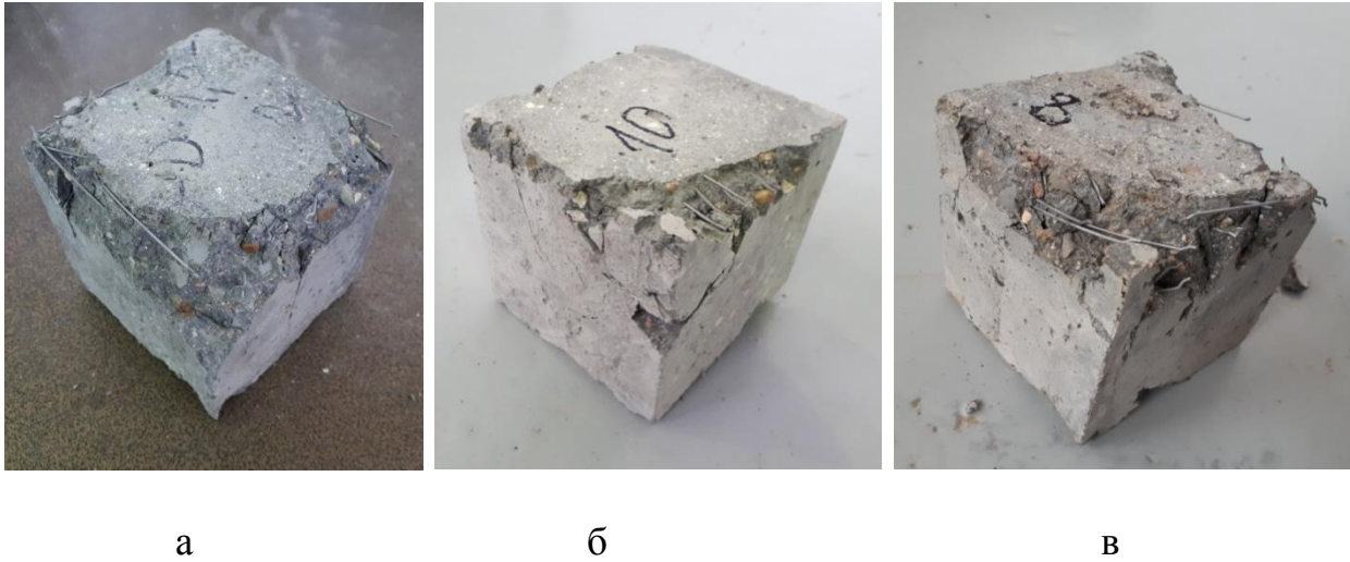
Рисунок 1- Результат определения прочности покрытия из фибробетона при действии динамических нагрузок (ударная вязкость) образцов с процентом армирования 1,5%: а) Фирма «Dramix». б) Фирма «Иннотех». в) Фирма «Hendrix».
