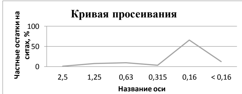
Рисунок 2. Кривая просеивания частных остатков
