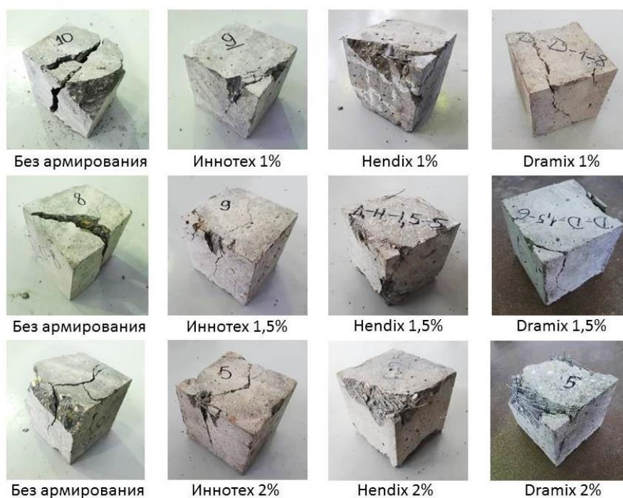
Рисунок 3. Образцы после разрушения
