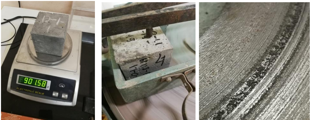
Рисунок 3 - Определение истираемости бетона: а) взвешивание образцов до испытания; б) образец в приборе ЛКИ-3; в) образование металлической крошки при проведении испытания.
