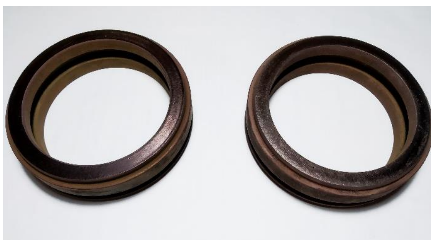
Рисунок 2 – Седла, напыленные нитридом титана
