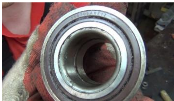
Рисунок 2. Снятый ступичный подшипник заднего колеса Лада Гранта
