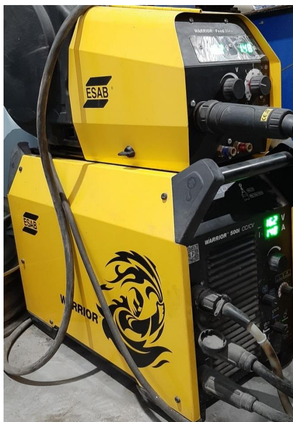
1 сурет - Аргонды доғалы дәнекерлеу аппараты Warrior.
