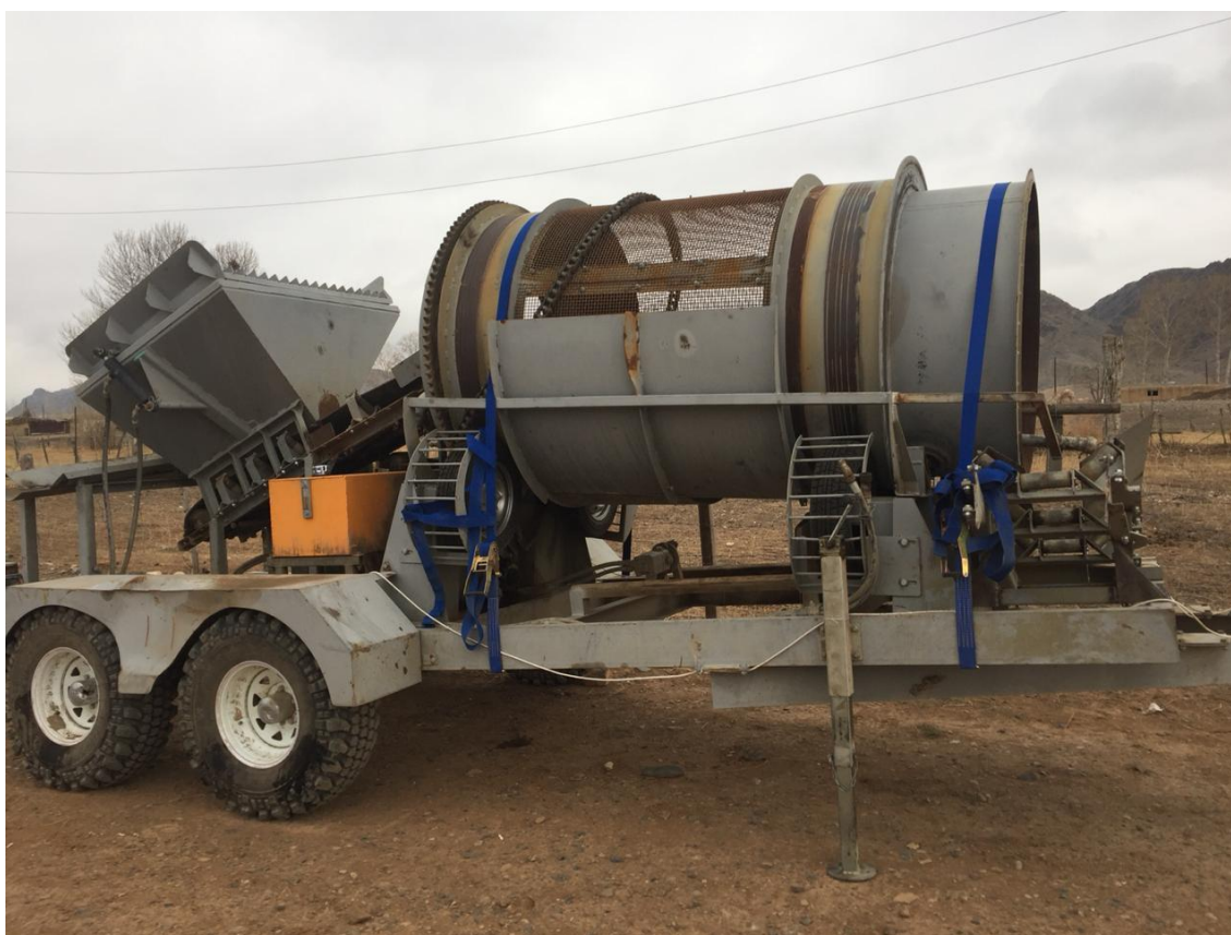
Рисунок 1 – Скруббер-бутара для промывки горной породы Повышение долговечности техники это один из важнейших факторов
