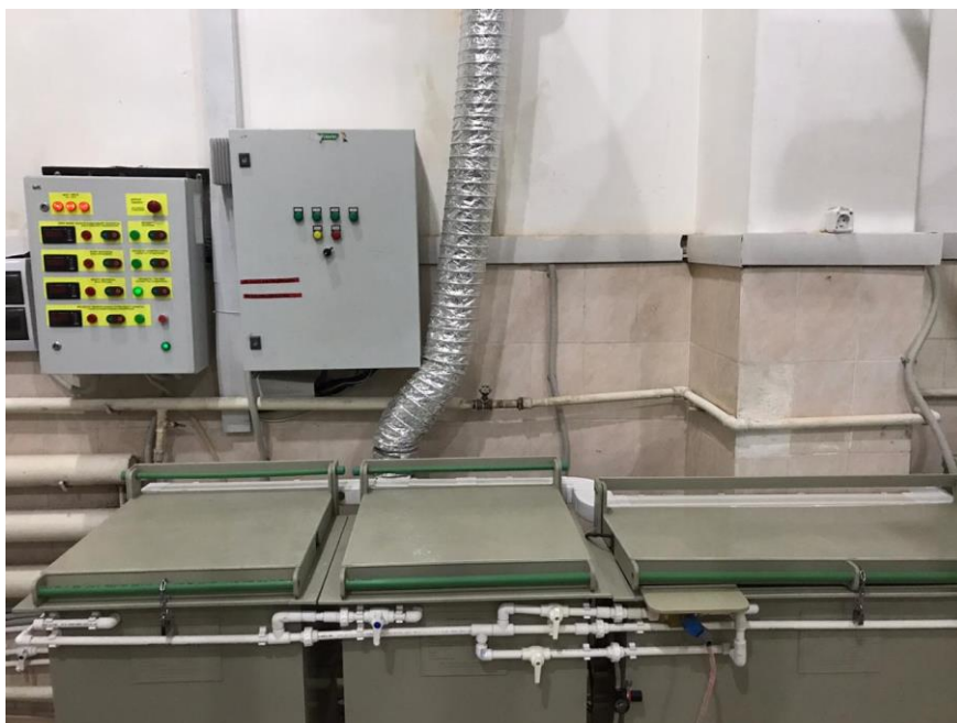
Рисунок 3. Внешний вид и модель установки электролитно-плазменной обработки.
