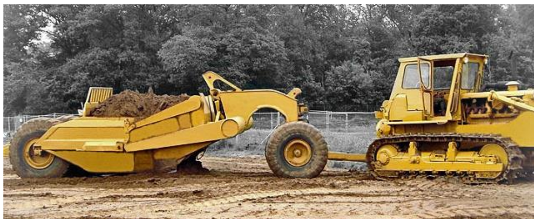
1 - сурет. Шарлы тіркеме құрылғысы бар жартылай тіркемелі скрепер
