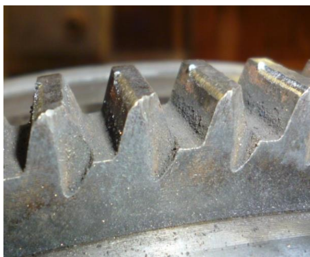
б) износ зубьев венца
