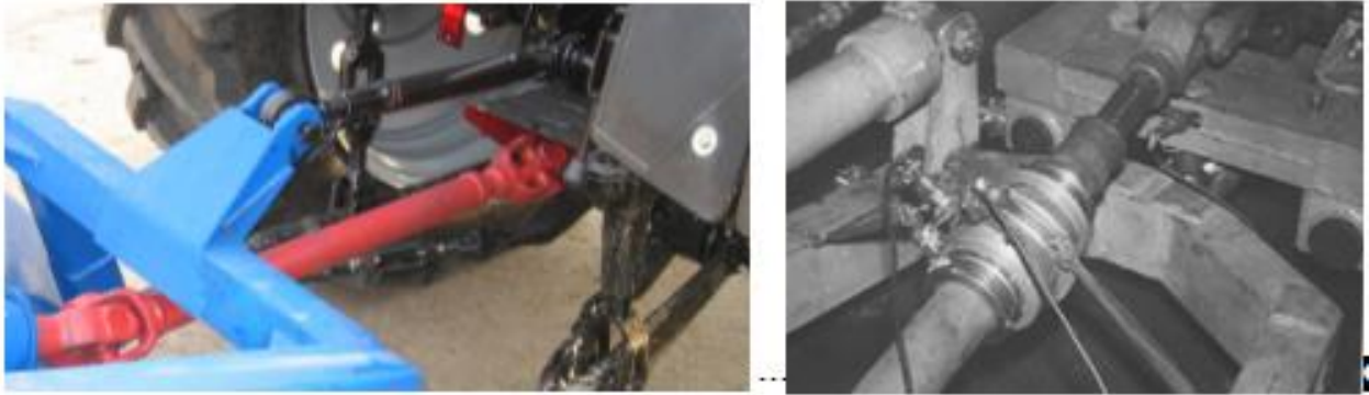
Рисунок 6 - Вал привода рабочего роторного органа ударного действия, с установленными на нём тензодатчиками.
