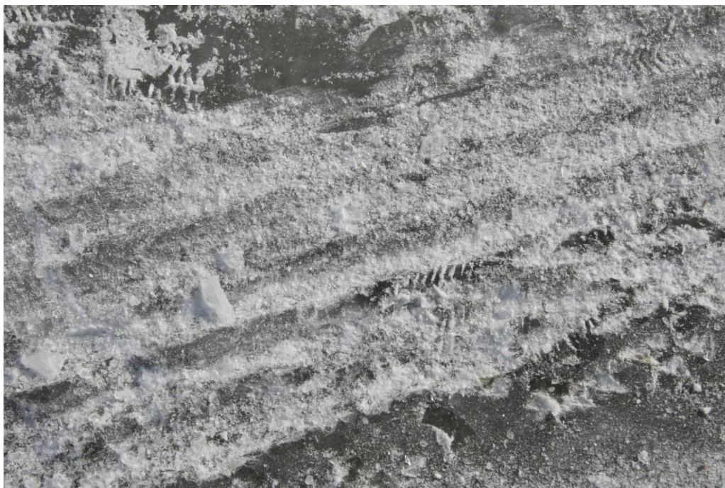
Рисунок 5 – След от прохода бойков льдоскалывателя по разрушаемому льду
