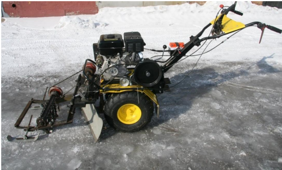
Рисунок 2 - Общий вид льдоскалывающей машины с цепным рабочим органом
