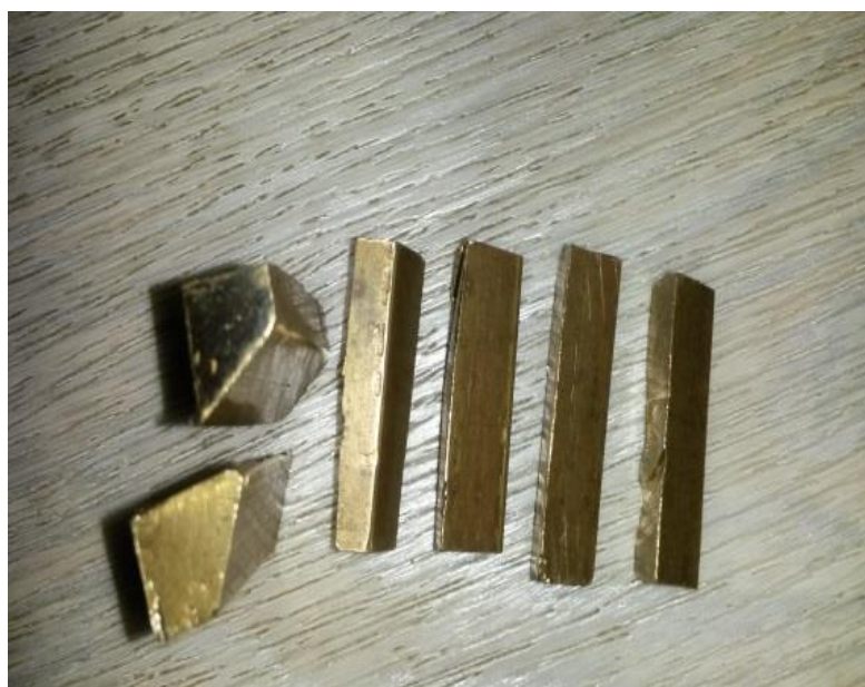
Рисунок 2. Подготовка образцов для электролитно-плазменной закалки из алюминиевой - железистой бронзы БрАМЖц10-3-1,5.
