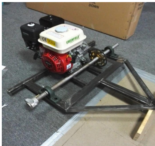
Рисунок 4 – Процесс сборки. Установка двигателя на раму
