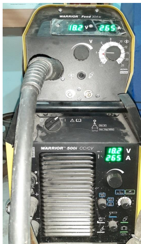
1 сурет - Аргонды доғалы дәнекерлеу аппараты Warrior.
