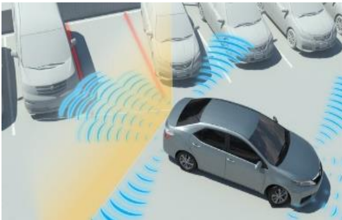
Рисунок 1.Фрагмент работы системы автоматической парковки
