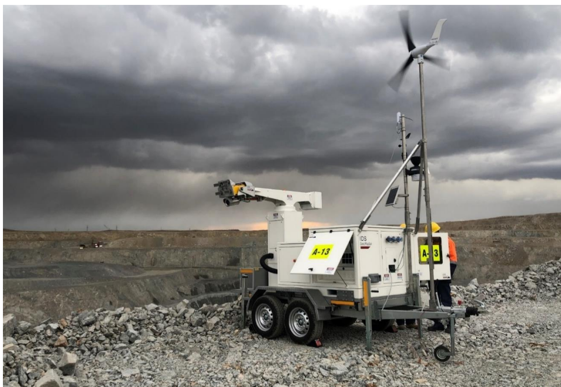
Рисунок 4. Мониторинг устойчивости бортов помощью IDS Georadar на месторождении Актогай.
