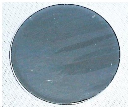
Рисунок 1 – Монетная заготовка с зонами оптической неоднородности
