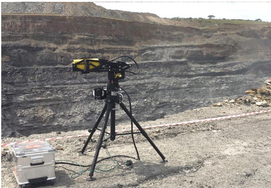
Рисунок 5. Портативный интерферометрический радар HYDRA-X с синтезированной апертурой.
