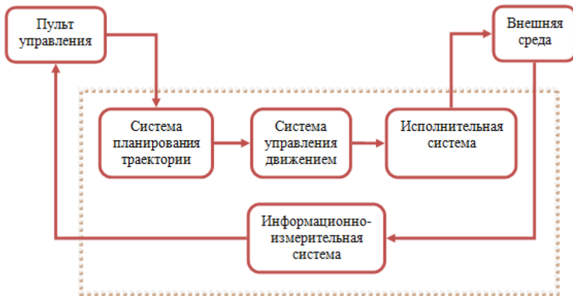
Рисунок 1. Общая схема управления движением мобильным роботом
