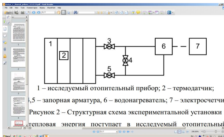
1 – исследуемый отопительный прибор; 2 – термодатчик; 3,4,5 – запорная арматура, 6 – водонагреватель; 7 – электросчётчик. Рисунок 2 – Структурная схема экспериментальной установки
