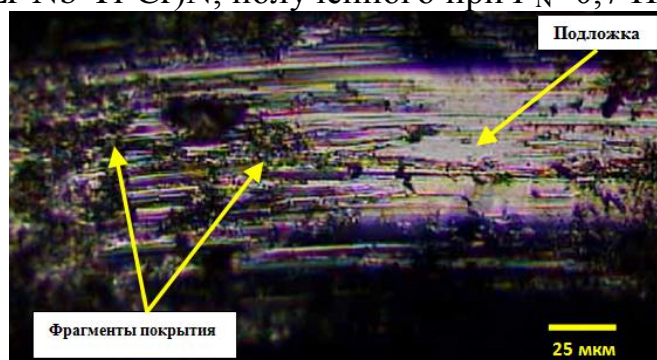
Рисунок 5 – Изображение сохранившихся фрагментов покрытия на дне царапины после воздействия алмазного индентора
