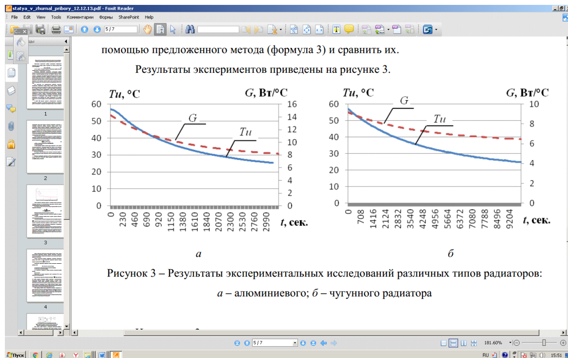
Рисунок 3 – Результаты экспериментальных исследований различных типов радиаторов: а – алюминиевого; б – чугунного радиатора.
