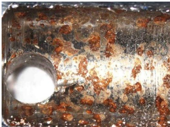
Рисунок 1. Воздействие коррозии на баковое оборудование химико-металлургического цеха
