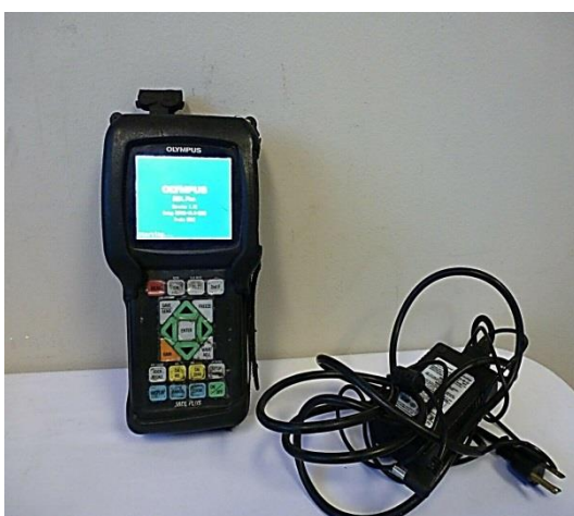
Рисунок 2- Ультразвуковой толщиномер с презентацией A- scan Olympus Model 38DL
