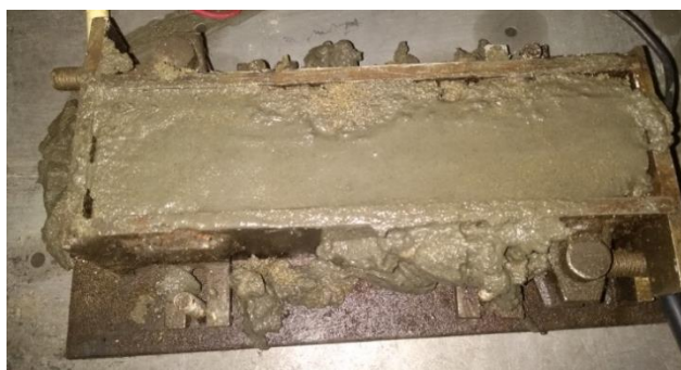
Рисунок 3 – Форма для определения удельного сопротивления бетона Бетонная смесь укладывается в форму размером 7x7x20 см, у которой
