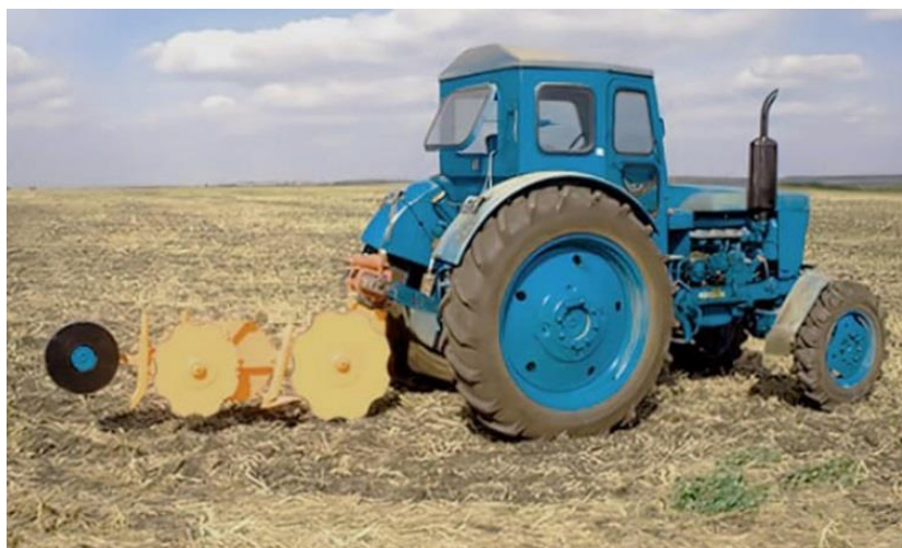
Рисунок 2 – Опытный экспериментальный образец модели дисковой посевной секции при его полевой проверке
