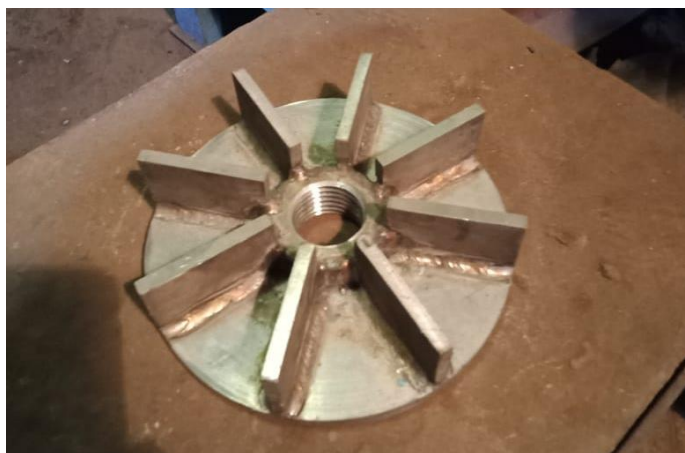
Рисунок 2 – Крыльчатка погружного насоса из стали 12Х18Н10Т подвергающейся абразивному и коррозионному износу
