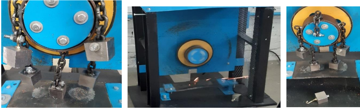
Рисунок 5 – Сравнительные испытания различных соединений бойков с гибкими тягами
