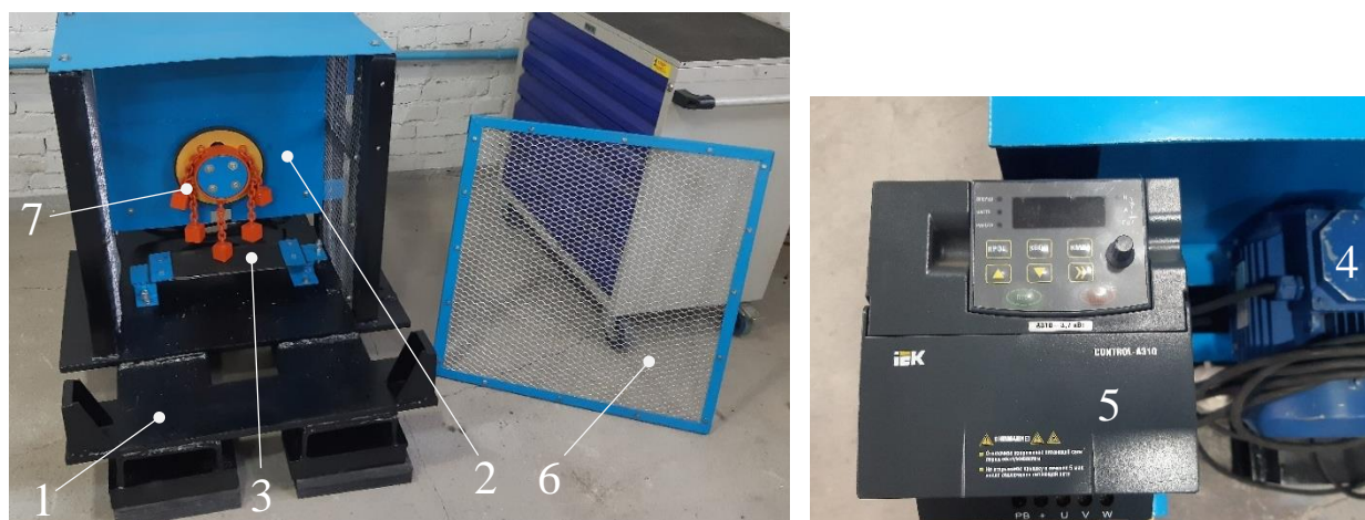
1 – рама; 2 – испытательная камера; 3 - нагрузочно-имитирующее устройство; 4 – электродвигатель; 5 - частотный регулятор скорости вращения электродвигателя; 6 – защитная сетка камеры; 7 – испытываемая УРС
