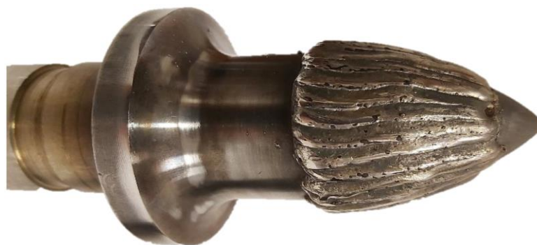
Рисунок 2. Твердое покрытие, нанесенное роботизированным процессом GMAW на рабочую поверхность конической кирки.
