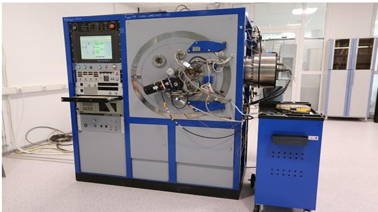
Рисунок 2 - Внешний вид аппарата плазменного распыления "Поток" (ПРА).
