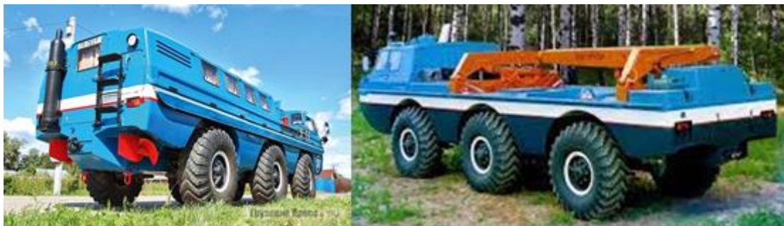
Рисунок 3 - Трёхосный полноприводный плавающий автомобиль ЗИЛ-49061 «Синяя птица»
