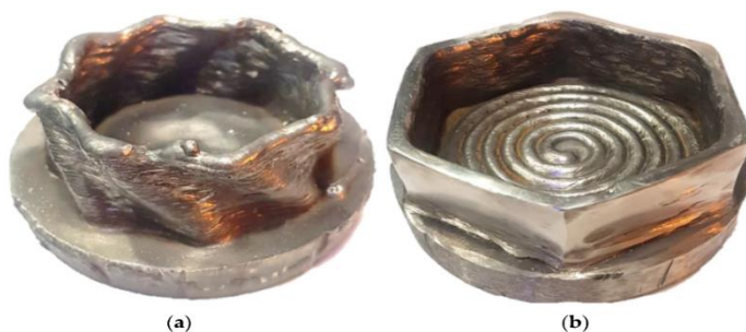
Рисунок 1. Изображение примеров деталей, изготовленных WAAM, (а) изображена необработанная деталь, (б) показана деталь, обработанная снаружи.
