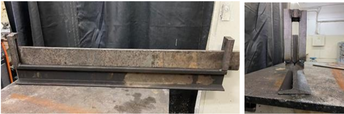
Рисунок 2 - Приспособление для гибки ромбовидной обечайки
