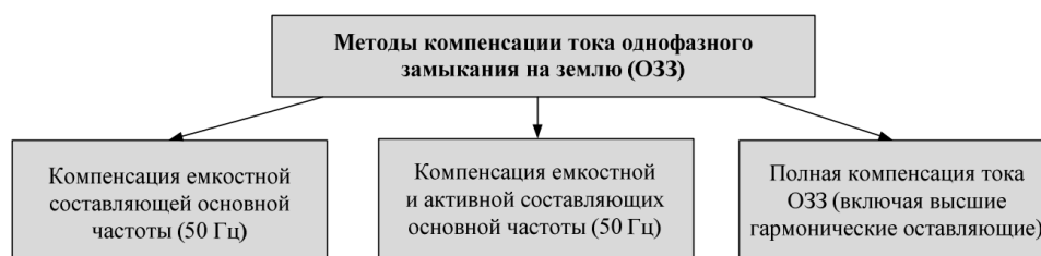
Рисунок 1 - Методы компенсации тока однофазного замыкания на землю
