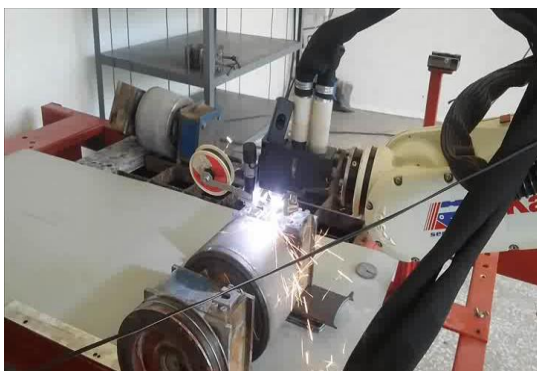
а – робот перемещает микроплазмотрон вдоль поверхности вращающейся цилиндрической детали
