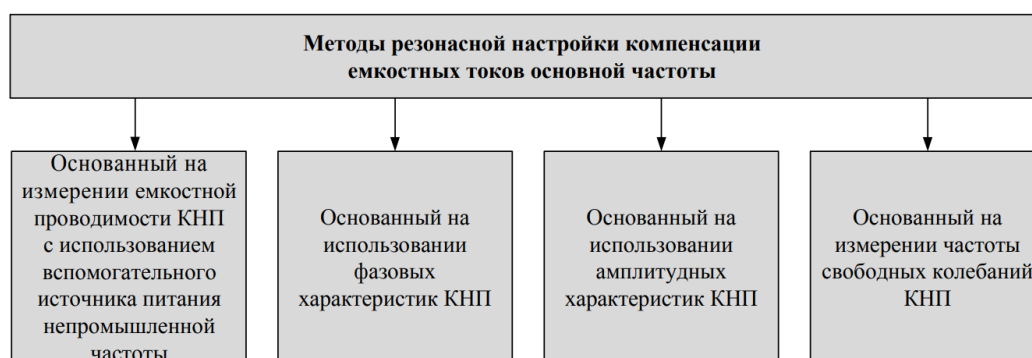
Рисунок 4 - Классификация методов автоматической настройки компенсации емкостной составляющей основной частоты токов однофазного замыкания на землю
