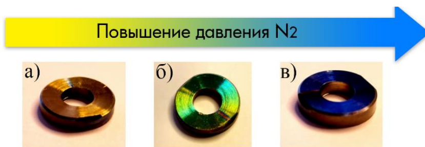
Рисунок 2 - Образцы после магнетронного распыления при различной азотной стехиометрии: а) при 5 Па, б) при 10 Па, в) при 20 Па.
