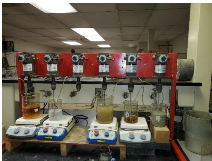
Рисунок 1 - Стандартные биореакторы с перемешиванием, подогревом и воздушным насосом
