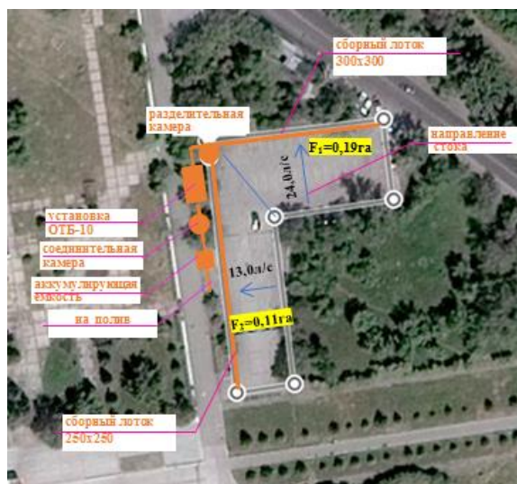
План парковки с очистными сооружениями поверхностных вод
