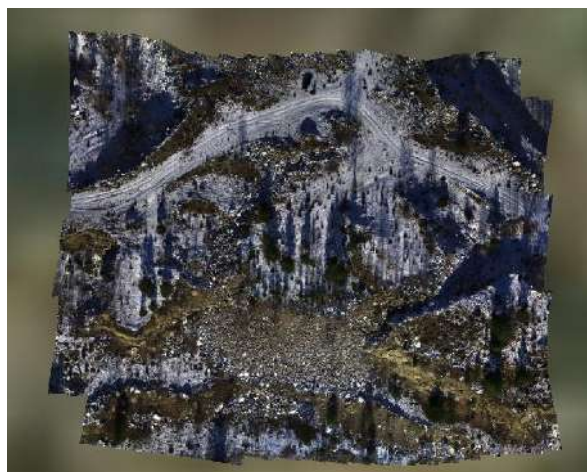
Сурет 2. Ортофотожоспар фрагменті, DJI Phantom 4 Multispectral ҰҰА көмегімен алынған
