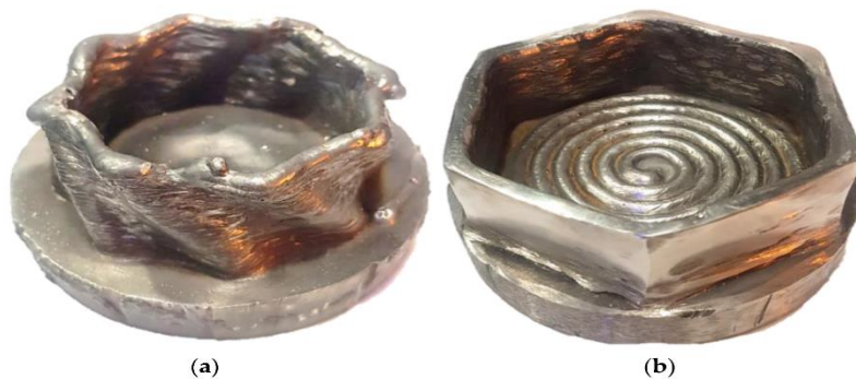
Сурет-1-WAAM компаниясы шығарған бөлшектер мысалдарының суреті, (а) өңделмеген бөлікті көрсетеді, (б) сыртқы өңделген бөлікті көрсетеді
