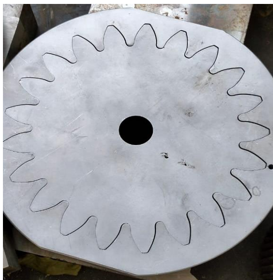
Рисунок 3 – Изготовление зубчатого колеса на электроэрозионной проволочной вырезном станке.
