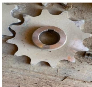
Сурет 2- Қарқынды тозуға ұшырайтын КСМ конвейерінің 12Х18Н10Т тот баспайтын болаттан жасалған жұлдызшасы
