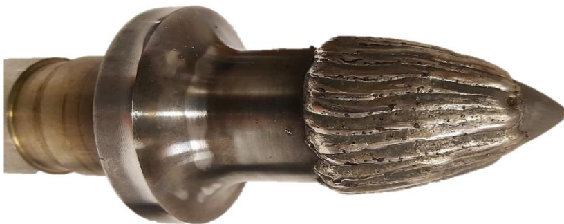
Сурет-2- Конустық ілмектің жұмыс бетіне роботты GMAW процесі арқылы қолданылатын қатты жабын
