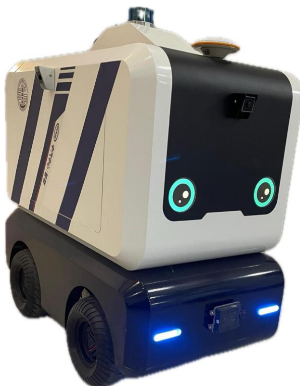
Рисунок 3- Роботизированная мобильная платформа на базе автопилота (с LiDAR)
