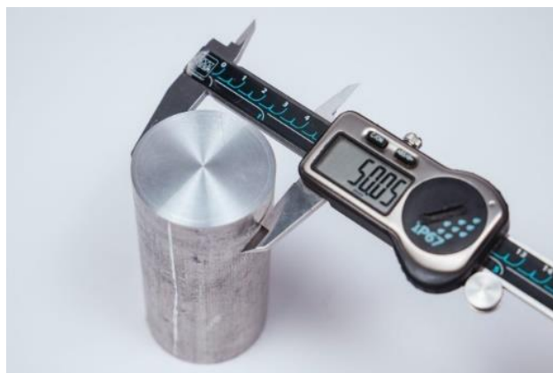
Рисунок 1 - Образец для электроискровой наплавки из сплава EN AC-45000
