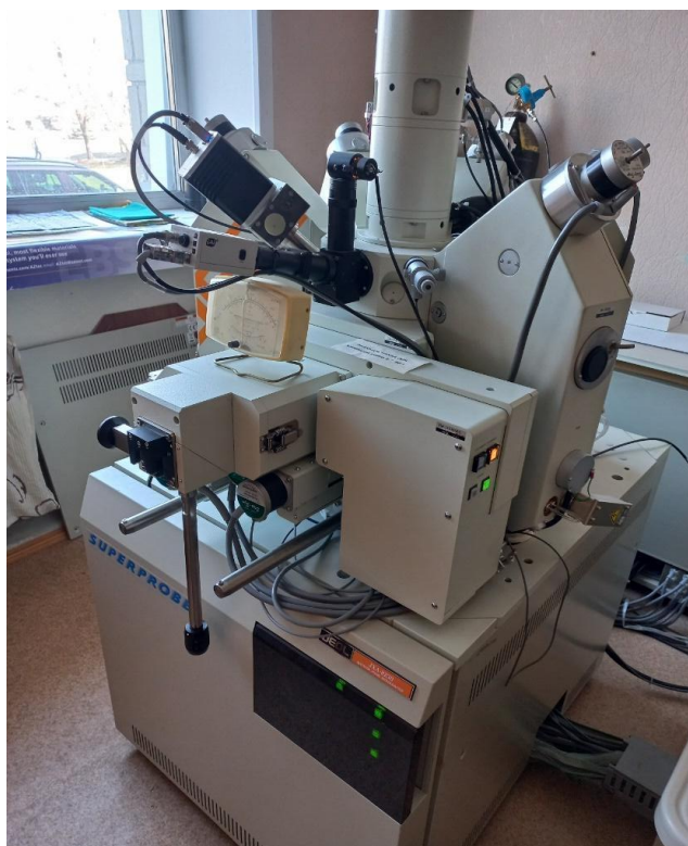
Рисунок 3.11 – Микрозонд JEOL JXA-8230 Electron Probe Microanalyzer (фото Агеевой О.В.)
