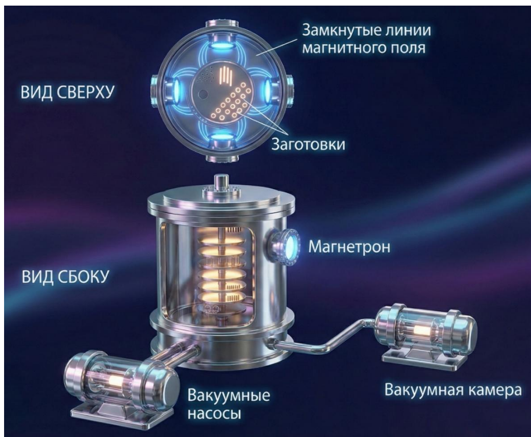
Рисунок 2.6 - Система нанесения покрытий магнетронным распылением с замкнутым полем
