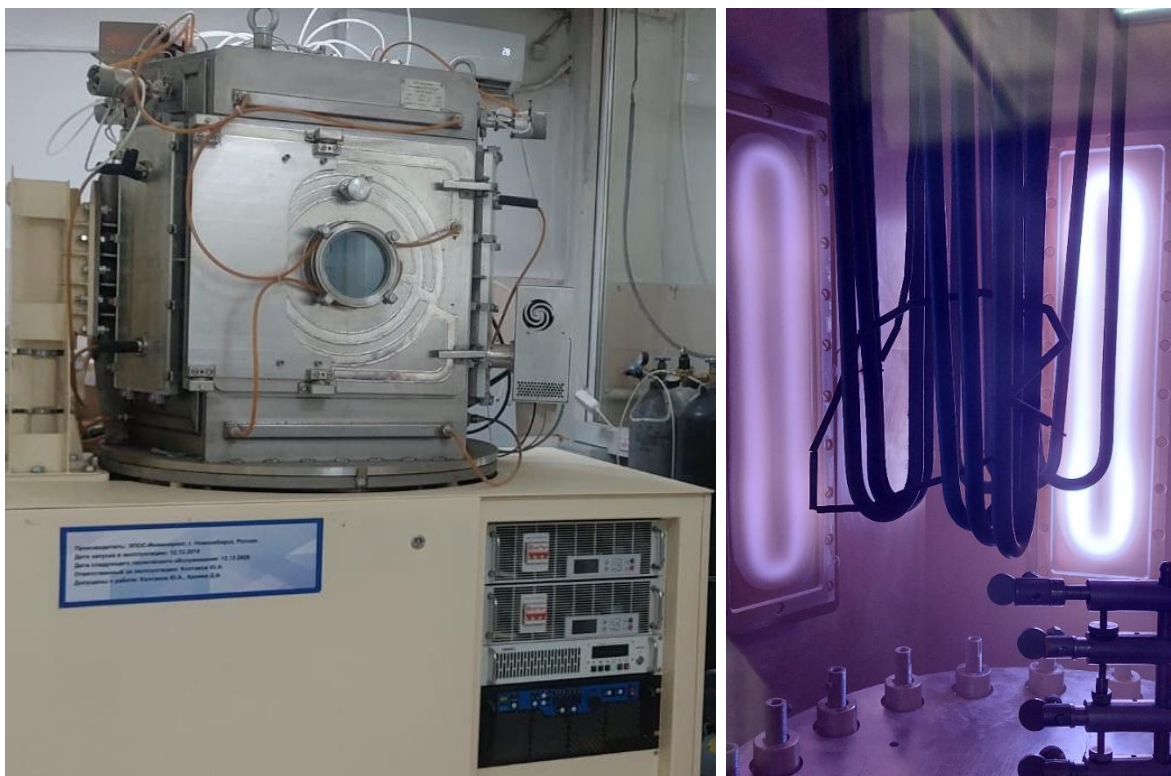
Рисунок 4.2 – а) установка МН EPOS-PVD-440, б) вид плазмы в процессе МН системы TaCu
