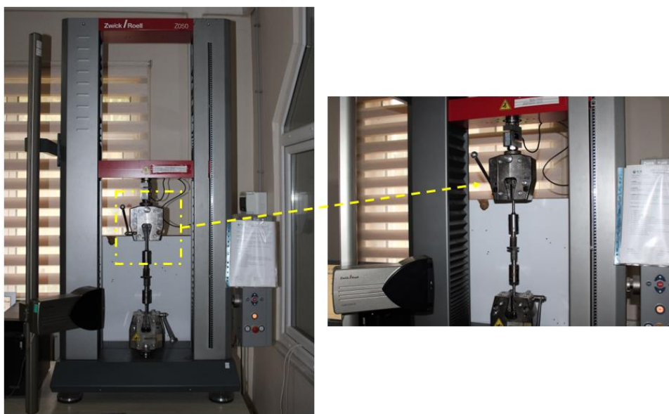
2.9 сурет - Zwick/Roell Z050 созылу сынағы машинасы
