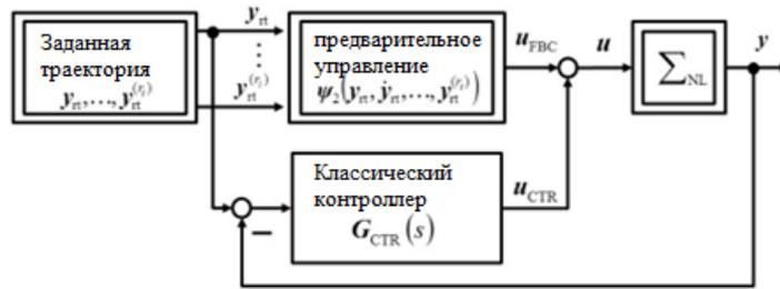
Рисунок 3.6 – Общая схема траекторного управления нелинейной системой с плоским выходом
