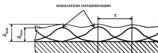
Рисунок 2.1 – Схема формирования покрытия равномерной толщины  $\tau$  шаг напыления,  $\delta_{max}$  наибольшая толщина покрытия,  $\delta_{min}$  наименьшая толщина
