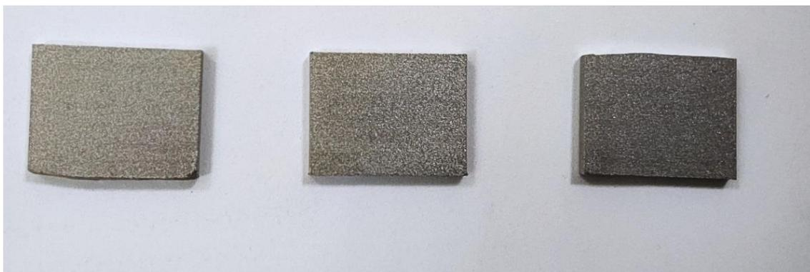
Рисунок 2.3 – Металлические подложки из титанового сплава Ti6Al4V
