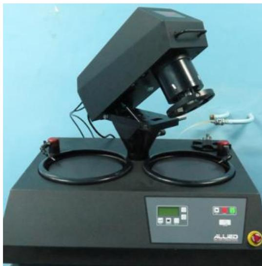
Рисунок 2.3 – Горизонтальный шлифовально-полировальный станок «DualPrep ЗРН»
