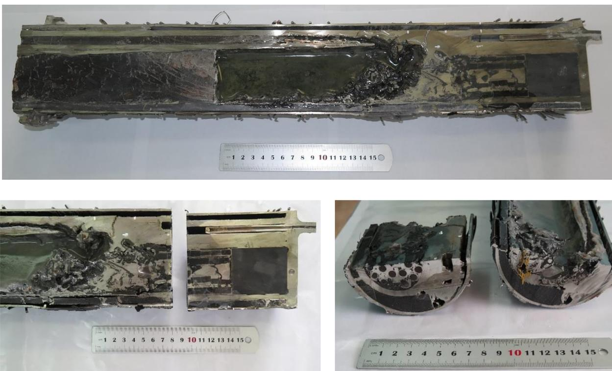
Рисунок 5.1 – Продольный и поперечные срезы испытательной секции
